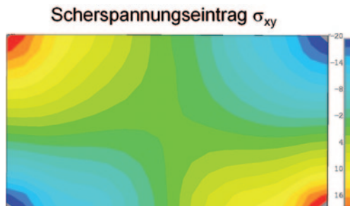
Abb. 12: Vergleich von Simulation (unten) und Messung (oben) des abkühlungsbedingten Scherspannungseintrags beim PSSO-4 Package
