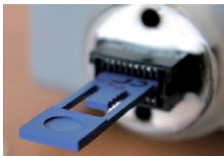
Abb. 1 DSC-Chip gebaut vollständig in LTCC-Technik
