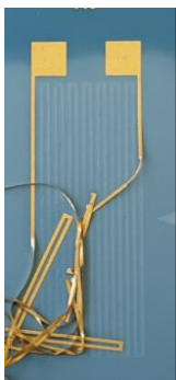
Abb. 1: Ablösen der Goldelektrode von der LTCC nach dem Säuretest
